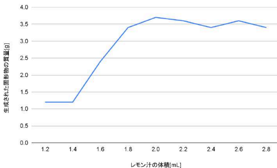
図8:牛乳50mlに加えたレモン汁の体積と生成された固形物の質量の関係
