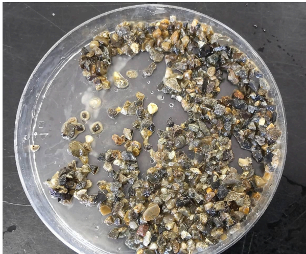
図5-1 液状化後の上部の砂
