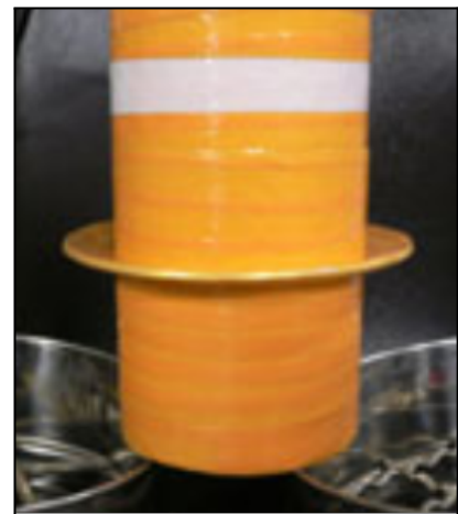
図1 浮上防止が施されたマンホール管
