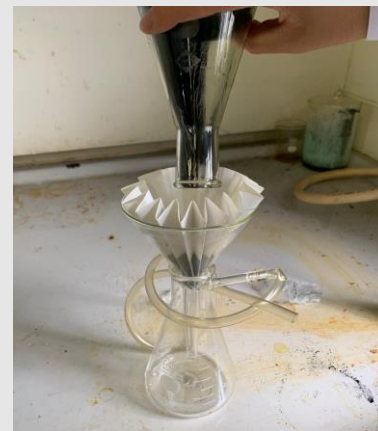
図18 活性炭を用いて濾している様子
