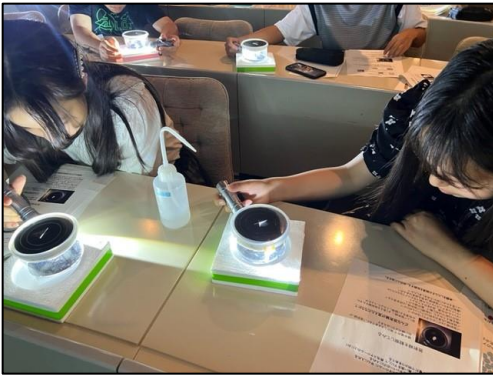
霧箱で放射線の可視化の実験の様子
