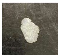
図1:洗浄後のろこ 白い油が残っている 様子がわかる
