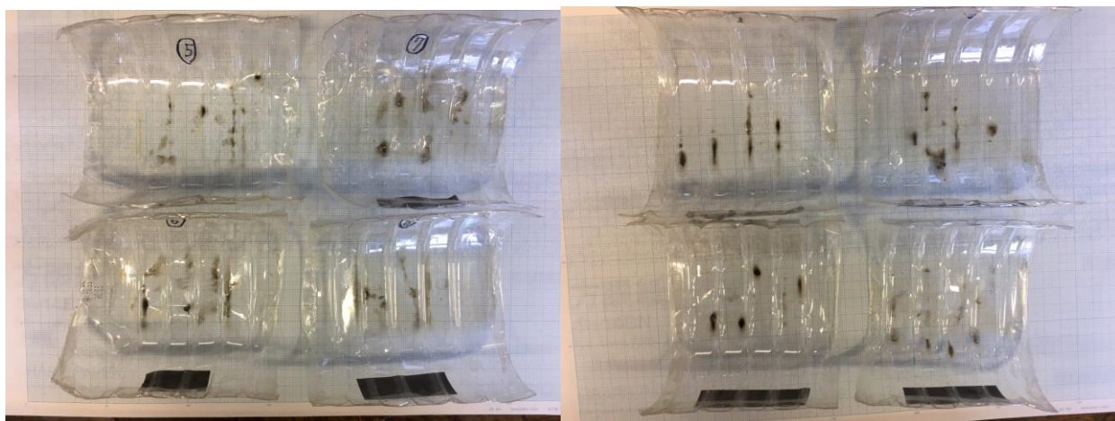
写真1 7月16日時点の防カビ剤を塗布していないペットボトル 写真2 7月16日時点の防カビ剤を塗布したペットボトル
