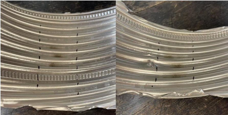
写真7 12月1日時点の防カビ剤を塗布していないエアコンダクト 2つ
