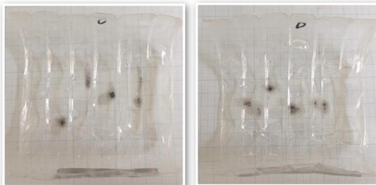
写真3 7月22日時点の防カビ剤を塗布していないペットボトル容器（左を皿C，右を皿Dとする）
