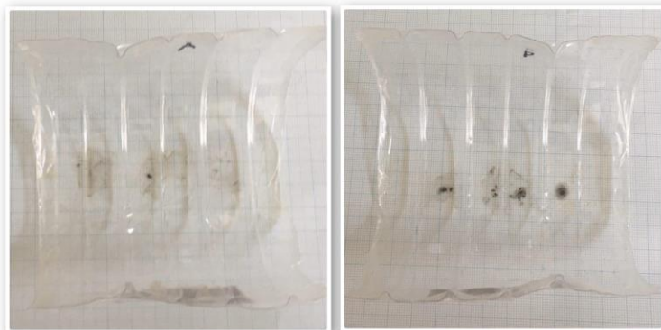
写真4 7月22日時点の防カビ剤を塗布しているペットボトル容器（左を皿A，右を皿Bとする）
