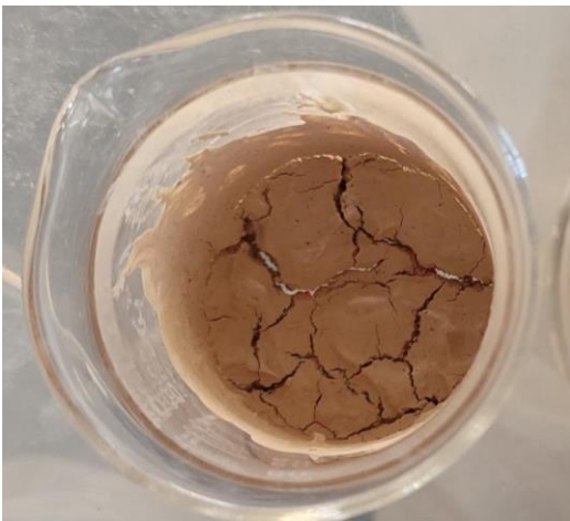
図6: ビーカーにペーストを入れ800 Hzの音波を5分間流し、2週間以上乾燥させた際の亀裂の様子。(水:粉=2:1(質量比))
