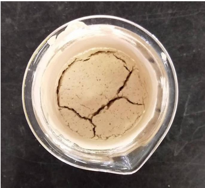
図4: ビーカーにペーストを入れ音波は流さず, 2週間以上乾燥させた際の亀裂の様子。(水:粉=1:1 (質量比))
