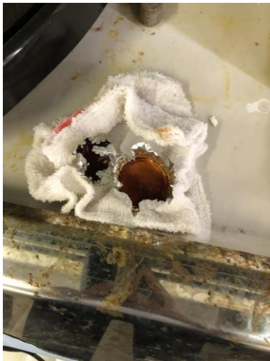
↑濡れ雑巾と氷で生成物を急冷している
