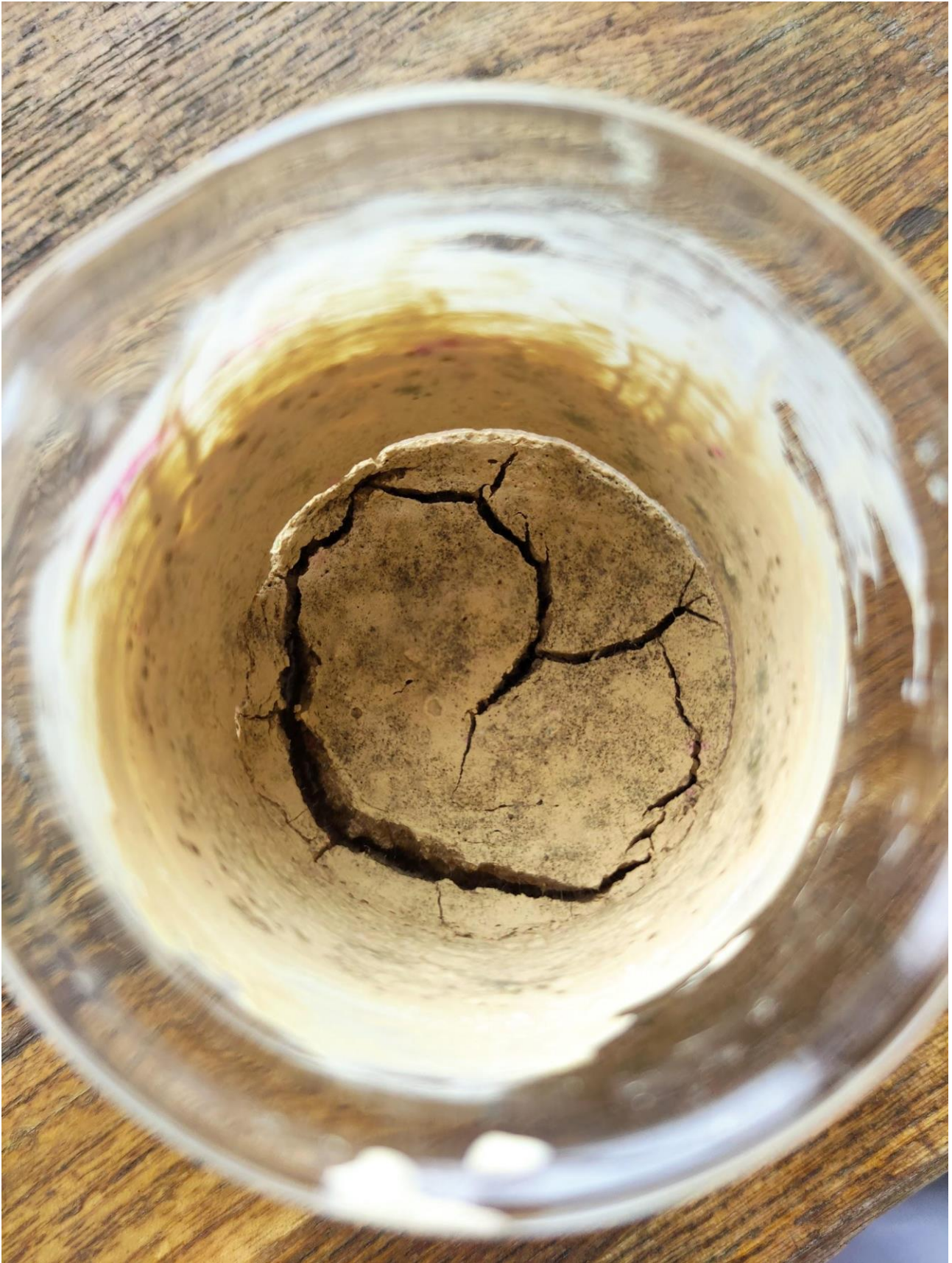
図1: ビーカーにペーストを入れ音波を流さず2週間以上乾燥させた際の亀裂の様子。(水:粉=2:1 (体積比))
