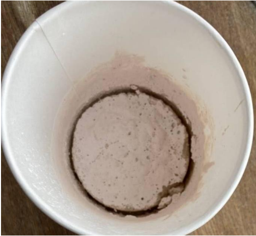
図3: ビーカーにペーストを入れ400 Hzの音波を5分間流し2週間以上乾燥させた際の亀裂の様子。(水:粉=1:1 (質量比))
