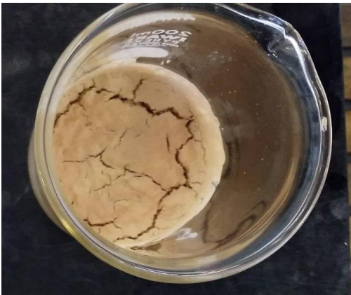
図8: ビーカーにペーストを入れ800 Hzの音波を5分間流し、2週間以上乾燥させた際の亀裂の様子。(水:粉=2:1(質量比))
