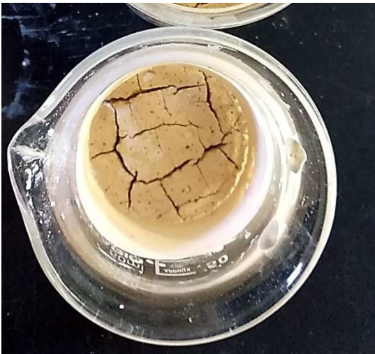
図5: ビーカーにペーストを入れ400 Hzの音波を5分間流し、2週間以上乾燥させた際の亀裂の様子。(水:粉=2:1(質量比))
