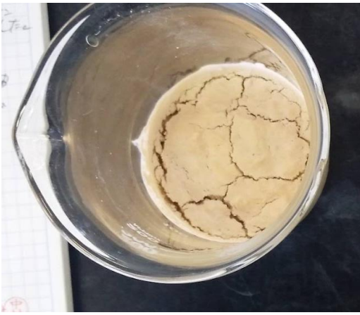
図7: ビーカーにペーストを入れ400 Hzの音波を5分間流し、2週間以上乾燥させた際の亀裂の様子。(水:粉=2:1(質量比))
