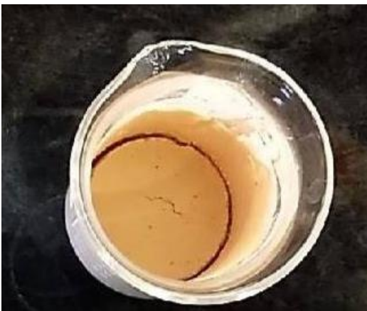
図9: ビーカーにペーストを入れ400 Hzの音波を5分間流し、2週間以上乾燥させた際の亀裂の様子。(水:粉=2:1(質量比))
