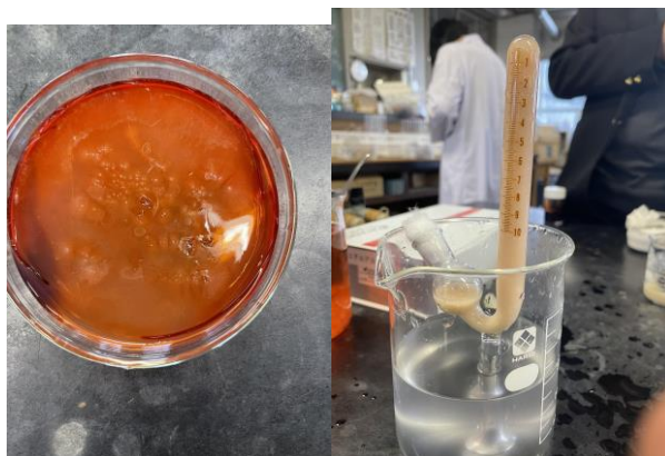
図2 コンゴレッド溶液をかけた後純水で洗い流した培地 図3 アルコール発酵の実験を行ったキューネ発酵管
