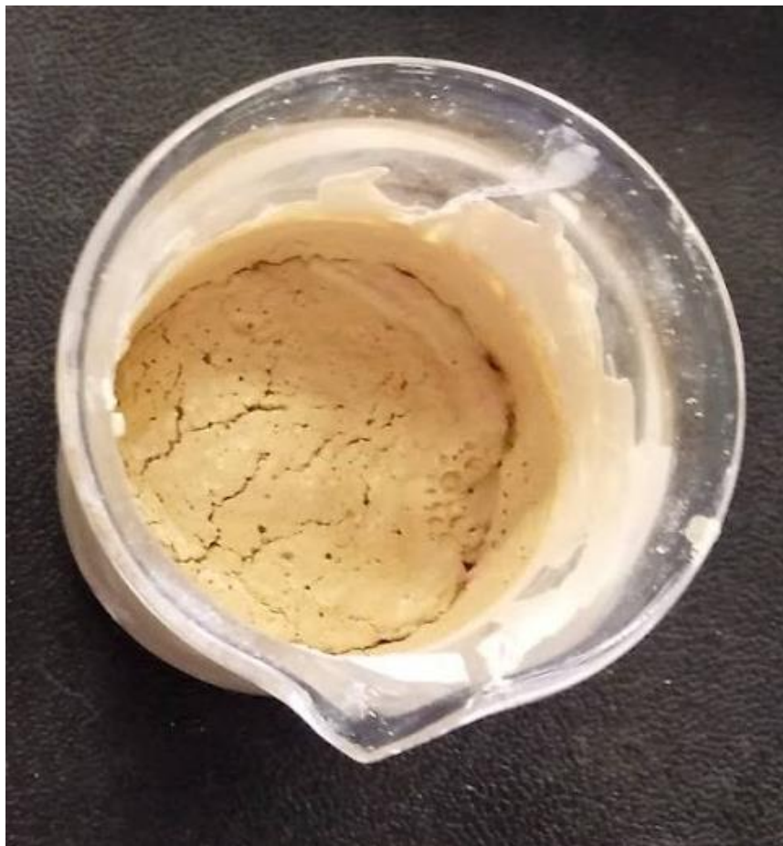
図2: ビーカーにペーストを入れ音波を流さず2週間以上乾燥させた際の亀裂の様子。(水:粉=1:1 (体積比))
