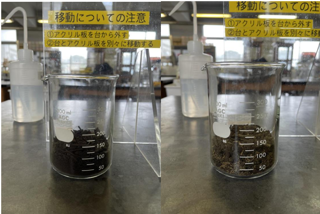
図1枚目が土50 g,2枚目が土45 g+竹の葉の粉末5 g
