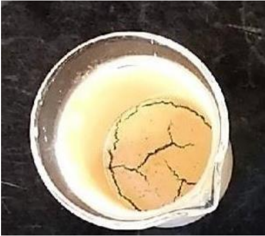
図10: ビーカーにペーストを入れ800 Hzの音波を5分間流し、2週間以上乾燥させた際の亀裂の様子。(水:粉=2:1(質量比))
