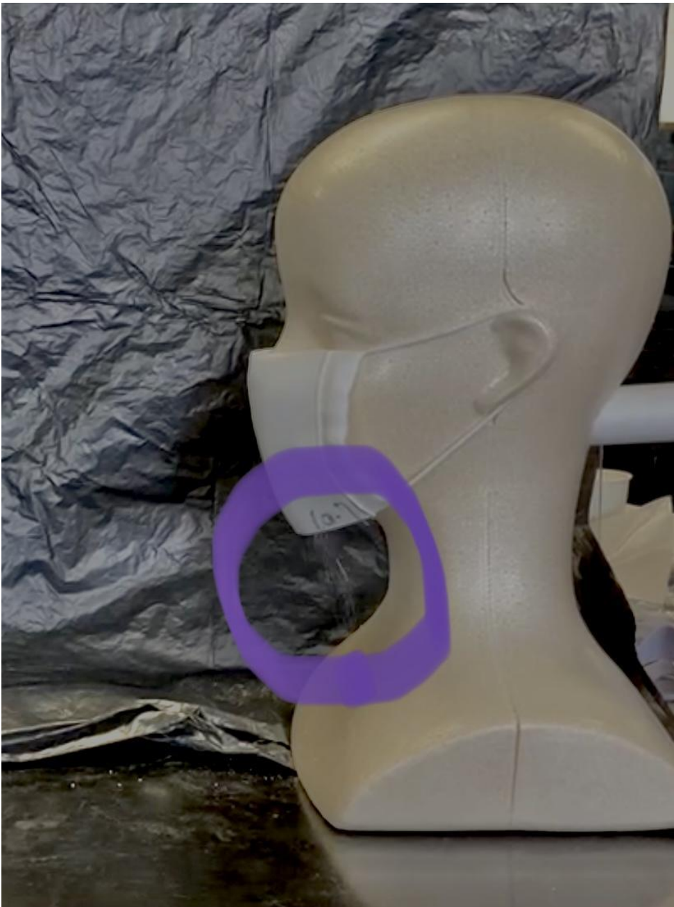
図4:平型の飛沫が飛散する方向
