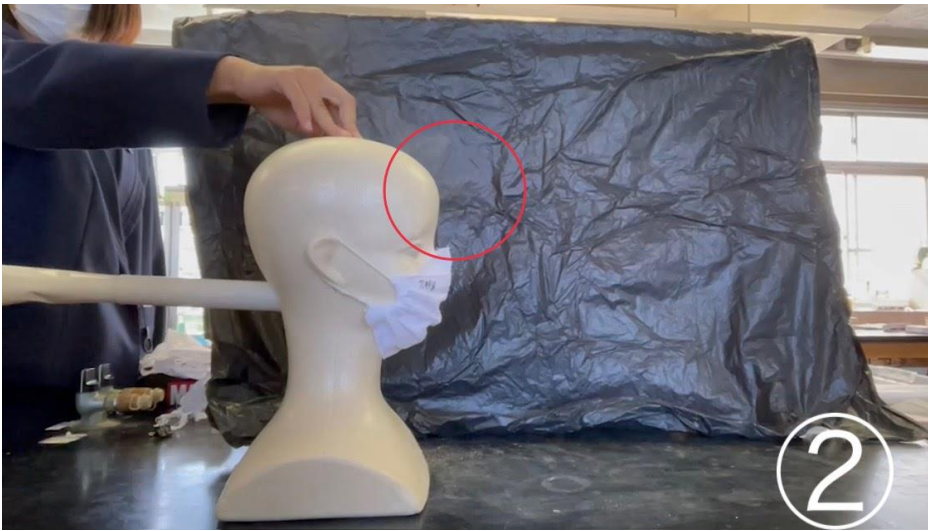
図9 タイプ2のマスクで行った実験における飛沫の様子 ・主に上部からの飛沫 ・タイプ1よりも少ない
