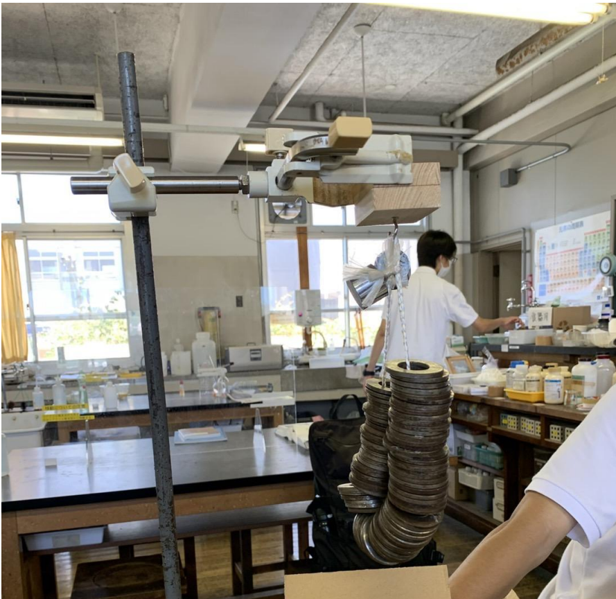
図1 接着の強度の測定方法
