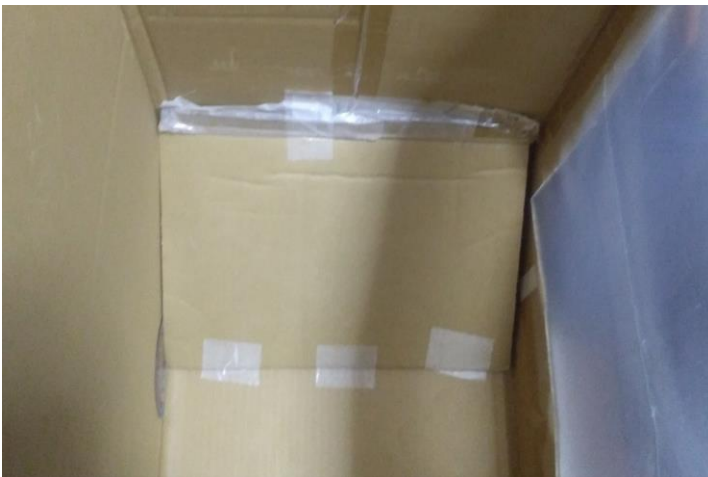
図 5 回収ボックスモデルの底の半分を傾斜の先端とした 45 度の傾斜をつけた様子
