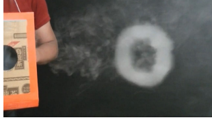
図1 空気砲による渦輪
