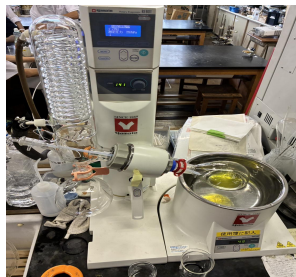
図2 エバポレーターを用いた溶剤抽出法
