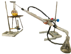
図1 水蒸気蒸留法の装置
