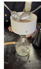
図5:アスピレーターを用いた吸引の様子
