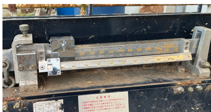
↑下の棒で1～100kg、 上の棒で百単位を計測できます。
