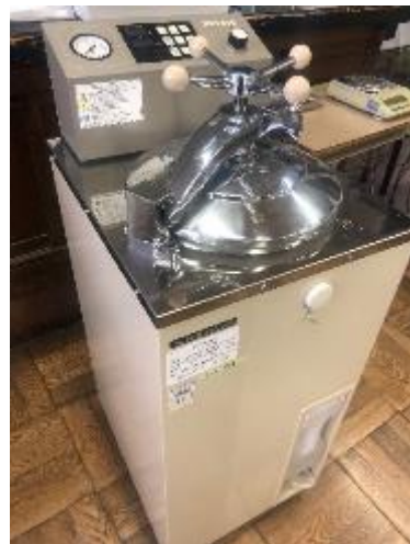
(写真9) オートクレーブ
