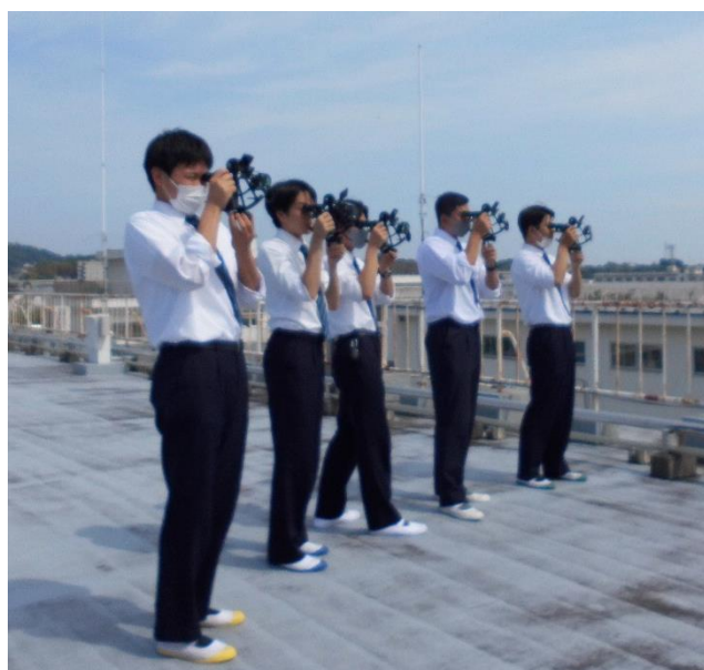
六分儀を使って太陽の高さを計っている様子
