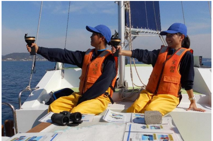
④計測した方位から船の位置を海図で求めます クロスベアリング実習
