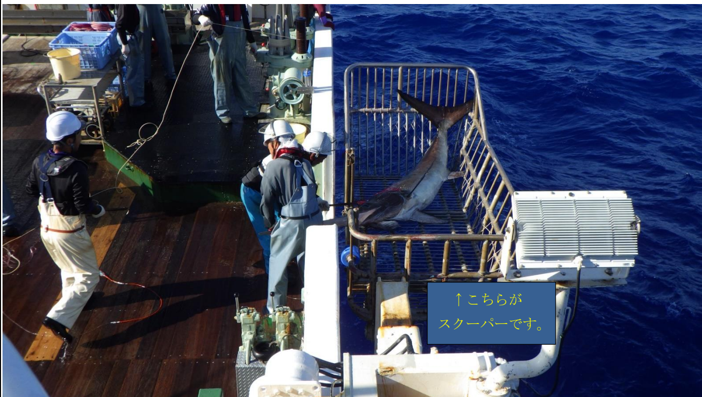
スクーパーという機械を使い船に魚を上げていきます。
