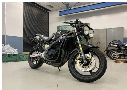
図 4 エンジン始動ができる状態まで組み立てられた車両
