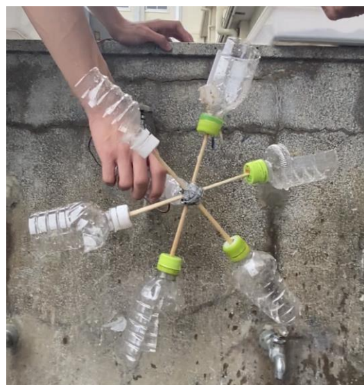
図3 自作した水力発電機
