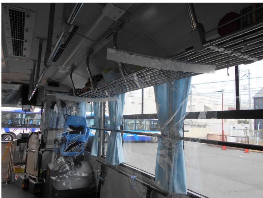
飛沫飛散対策のためのビニールカーテンの設置（スクールバス）
