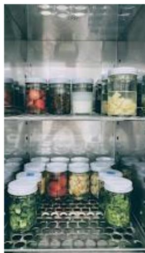
左の写真は、恒温器（インキュベーター）で酵母を育てている様子です。滅菌済みの瓶に部員が選択した食材と水を加えた上で、砂糖を加えた場合と加えなかった場合の2つの条件でそれぞれの食材で酵母を育てます。小麦粉は、ハイスピードミルによってコムギの種子をつぶしたものを我们用います。
