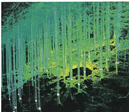
森林3次元計測システム「OWL」によって取得した点群データ
